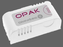
OPAK consente l'accesso tramite Bluetooth e da remoto (con Gateways) ed è studiato per porte con elettroserratura, garages, tornelli, etc.
