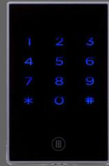
Il lettore da muro DIGIT2 è un dispositivo multitecnologia che permette l'accesso tramite tessere MiFare, Bluetooth, da remoto (con Gateways) e con codice. Adatto per porte con elettroserrature, garages, barriere, etc.
