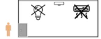
7. Se, invece, viene rilevato movimento in questi 5 minuti (una seconda persona presente in camera, ma che era in bagno), luce e aria continueranno a funzionare
