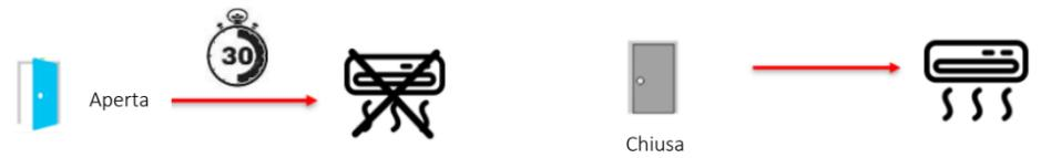
**Tempo di rilevamento sensore di movimento:** è il tempo durante il quale luce e aria rimarranno alimentati dopo che una persona ha abbandonato la stanza e parte dal momento in cui viene rilevata una chiusura porta. Se, passato questo tempo, non vengono rilevati altri movimenti, la centralina spegne luce e aria. Questo tempo è impostato a 5 minuti.
